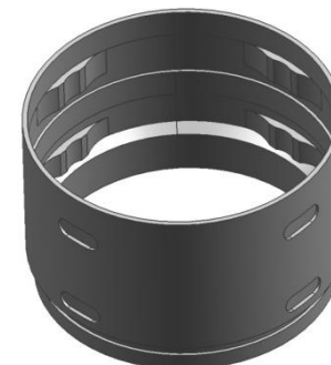
Габаритные размеры: D = 191 мм H = 121 мм Материал: титан
