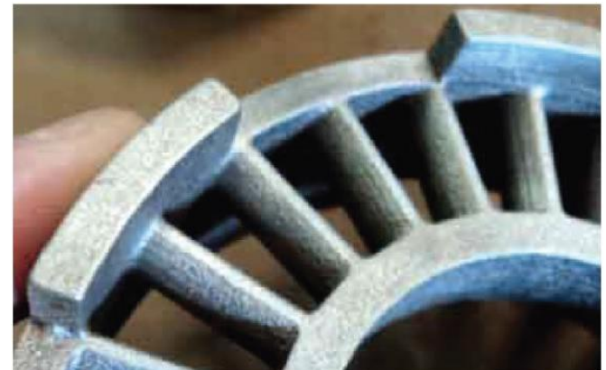
Аддитивная технология Износ после 600 часов.
